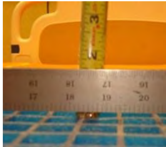
Abbildung 3-4: Messung der maximalen Tiefe
